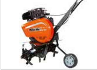
Колесо заднего хода служит для перемещения машины.
