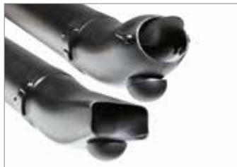
В стандартную поставку входят два воздуховыпускных наконечника с прямоугольным или круглым сечением, каждый из которых оснащен полусферой, которая позволяет класть его на землю с ровной поверхностью, чтобы снизить утомляемость оператора (BV 901).
