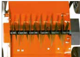
Ротор, состоящий из 15 стационарных ножей.
