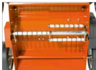
Ротор с 28 плавающими ножами на шариковых подшипниках и система смазки.
