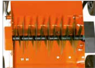
15 rögzített késből álló rotor.
