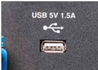
USB aljzat az elektronikus berendezések közvetlen áramellátásához.
