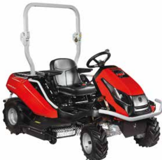
Szériában borulásvédő kerettel, első és hátsó lökhárítóval, oldalvédelemmel és biztonsági övekkel felszerelve a maximális védetség biztosítására a legösszetettebb helyzetben végzett műveletek során is ( CHEYENNE ).
