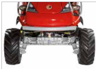
A gép nagyméretű, alacsony súlypontú futófelülete, ami maximális stabilitást biztosít egyenetlen talajon, folyópart és árok közelében.
