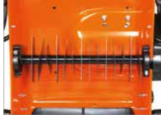
15 rögzített késből álló rotor.
