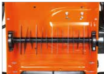
Ротор, состоящий из 15 стационарных ножей.
