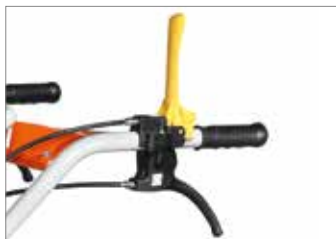
Рычаг на руле для переключения передач.
