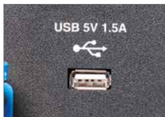
Выход с USB-разъемом для прямого питания электронного оборудования.
