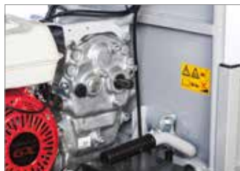
Независимый отбор мощности при 2100 об/мин.
