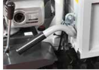
Otomatik kilitleme sistemli manuel eğme.
