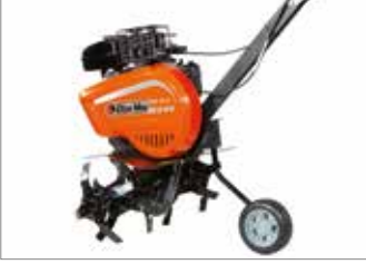
Makineyi taşımaya yarayan arka taşıma tekerleği.
