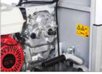
2.100 dev/dak hızında bağımsız güç çıkış ünitesi mevcuttur.
