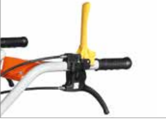
Vites değiştirmek için gidon üzerinde kol bulunur.
