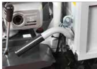
Basculamiento manual con sistema de bloqueo automático.
