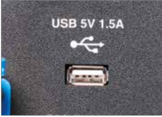
Elektronik ekipmana doğrudan güç sağlamak için USB soketli çıkış.
