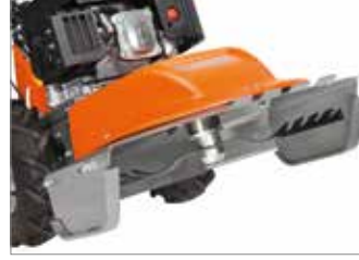
Çallığa ve yüksek bitki örtüsüne girişi kolaylaştırmak için ön açıklıklı kesme platformu (DEB 528).
