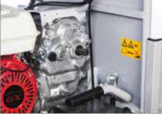
2.100 dev/dak hızında bağımsız güç çıkış ünitesi mevcuttur.
