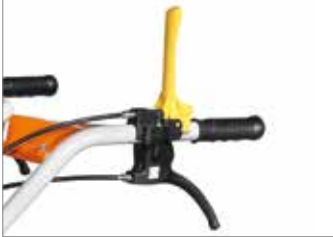
Рычаг на руле для переключения передач.
