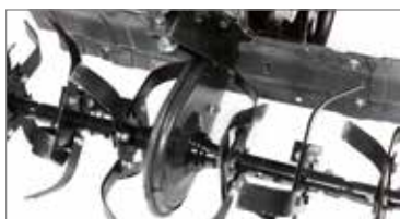
Усиленный картер трансмиссии для защиты от камней или случайных ударов.
