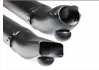
В стандартную поставку входят два воздуховыпускных наконечника с прямоугольным или круглым сечением, каждый из которых оснащен полусферой, которая позволяет класть его на землю с ровной поверхностью, чтобы снизить утомляемость оператора.
