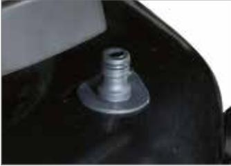
El conector rápido, "Deck Wash System", situado directamente sobre el plato de corte, permite dirigir el agua directamente al interior, facilitando las operaciones de limpieza del aparato de corte (106).
