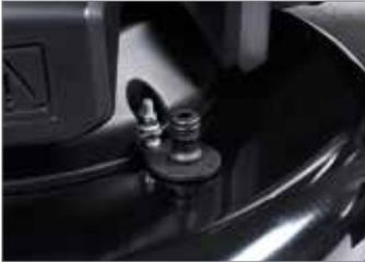
El conector rápido, "Deck Wash System", situado directamente sobre el plato de corte, permite dirigir el agua directamente al interior, facilitando las operaciones de limpieza del aparato de corte.
