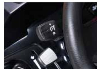
El modelo de **125** incluye de serie cruise control, función que permite seleccionar una velocidad de avance constante, optimizando de esta manera el tiempo de trabajo.
