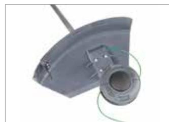
Cabezal Tap&Go EVO: cabezal ø 130 mm equipado con hilo de 3,00 mm, funcionamiento Tap&Go EVO.
