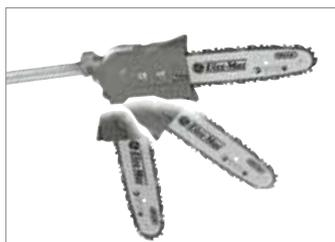
El sencillo sistema de fijación del equipo de corte permite ubicarlo en cinco posiciones entre 0° y 90° para obtener la máxima visibilidad de la zona de trabajo y un corte más preciso (**PPX 271**).
