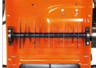
Rotor compuesto por 15 cuchillas fijas.
