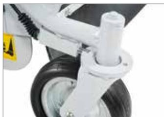
Ruedas delanteras pivotantes bloqueables desde la posición de conducción (modelo **100, 100 TR**).
