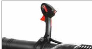
Los mandos son fácilmente accesibles; la empuñadura se regula en función del cultivo y se inclina hacia delante para favorecer la posición ideal de la muñeca durante los tratamientos realizados con el tubo en vertical.
