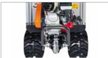
Protecção traseira em metal para garantir a segurança do utilizador.
