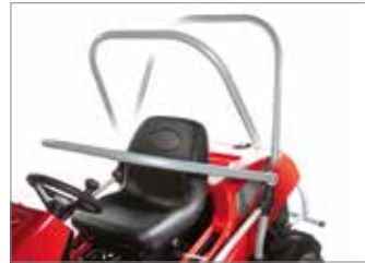
Equipados de série com rollbar, para-choques dianteiro e traseiro, proteções laterais e cintos de segurança para garantir a máxima segurança durante as intervenções, mesmo nas situações mais complexas.
