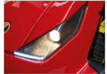
Faróis dianteiros com luzes halogéneas e lâmpadas de leds que asseguram uma boa visibilidade da área de corte, mesmo nas horas menos luminosas do dia.
