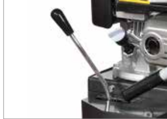
Comando seletor das velocidades com alavanca.
