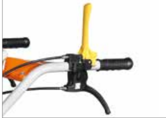
Alavanca no guiador para engate das mudanças.
