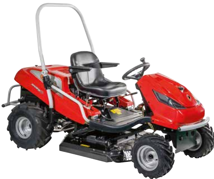
O piso de amplas dimensões e baixo centro de gravidade da máquina permitem a máxima estabilidade mesmo em terrenos irregulares ou próximo de margens de rios e valas.
