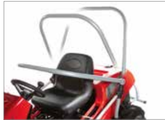
Szériában borulásvédő kerettel, első és hátsó lökhárítóval, oldalvédelemmel és biztonsági övekkel felszerelve a maximális védetség biztosítására a legösszetettebb helyzetben végzett műveletek során is.
