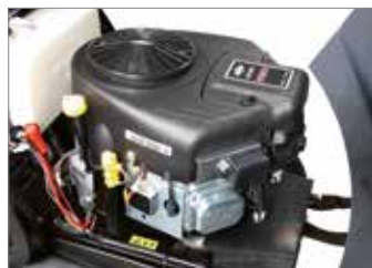
Kéthengeres Briggs & Stratton motor a különböző munkavégzési igények kielégítésére, 9000 m 2 felületig (123/22 V).
