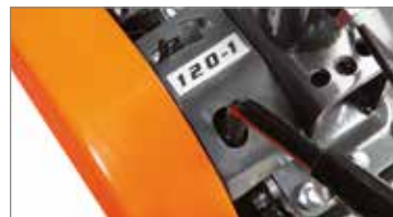
Külső, ergonomikus, könnyen hozzáférhető sebességfokozat-választó.
