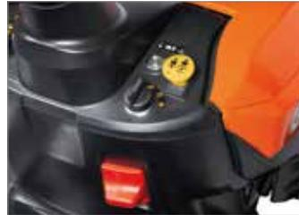
Para accionar las cuchillas sólo hay que presionar el pulsador del embrague electromagnético situado en el tablero. Este sistema garantiza la activación de las cuchillas sin contragolpes.
