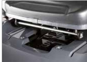
Posición de conducción ergonómica gracias al asiento regulable directamente desde el puesto de conducción; permite la regulación ideal en función de la estatura del operador (95/16 K).
