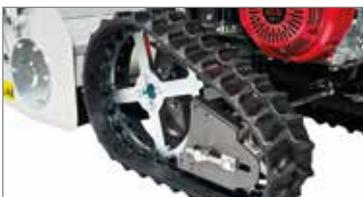
Sistema de tracción con orugas oscilantes que se adaptan a los distintos tipos de terreno (modelos **TR**).
