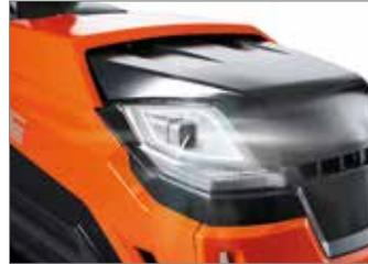
Faros de LED con función de luz diurna garantizan alta visibilidad aun en condiciones de baja luminosidad.
