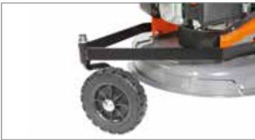
Modelos **DEB 517, 519 y 5159** dotados de diferencial que actúa sobre las dos ruedas traseras y sobre la rueda delantera pivotante a 360° para reducir el ángulo de viraje y facilitar la maniobrabilidad sobre cualquier terreno.
