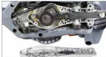
Caja de engranajes profesional de aluminio, mecanismo con piñón sobre cojinetes y bielas con rodillos de rodamiento: larga duración, funcionamiento silencioso y bajas vibraciones.
