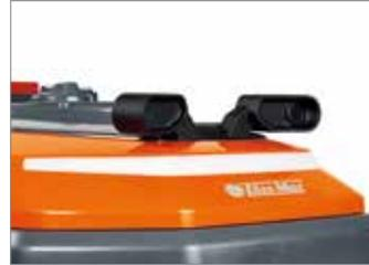
Detección por ultrasonido de los obstáculos, para aumentar las prestaciones y la seguridad del robot cortacésped; el sensor (opcional) puede detectar obstáculos de 10 cm de ancho y 15-20 cm de altura en la parte delantera.
