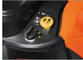
Para accionar las cuchillas, el operador debe simplemente pulsar la tecla de mando del embrague electromagnético situada en el salpicadero. Este sistema garantiza la activación de las cuchillas sin contragolpes.
