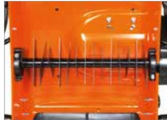
Rotor compuesto por 15 cuchillas fijas.
