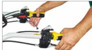
El freno de servicio y de aparcamiento se activa automáticamente al desactivarse el embrague, previniendo movimientos accidentales peligrosos.
