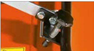
Sistema de regulación de la altura con memoria para reposicionar rápidamente la máquina a la altura deseada después de los desplazamientos.
