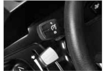
El modelo de **125** incluye de serie cruise control, función que permite seleccionar una velocidad de avance constante, optimizando de esta manera el tiempo de trabajo.
