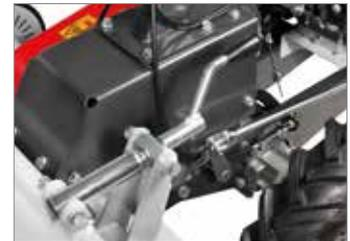
Regulación de la altura de corte mediante manivela con tornillo sinfín. Finamente regulable de 20 a 80 mm.
