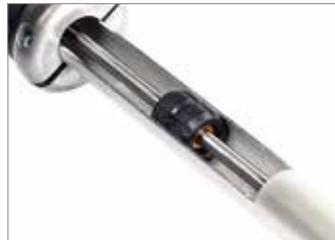
Varilla de transmisión rígida, Ø 8 mm: alta fiabilidad gracias al eje de transmisión rígido que se desliza sobre 6 rodamientos autolubrificantes.
