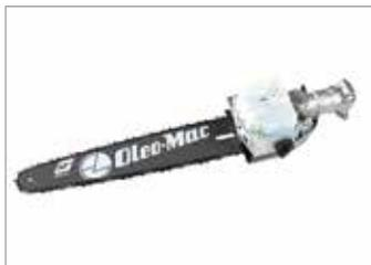
Sistema de corte, ligero y compacto, equipado de serie con espada con punta piñón y diseño tipo carving. La espada mide 12" (30 cm) y lleva una cadena de 1/4 x .043.
