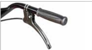
Regulación centralizada de la altura de corte controlada mediante una palanca situada directamente en la empuñadura, para asegurar la máxima comodidad al usuario.
