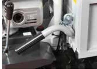
Basculamiento manual con sistema de bloqueo automático.
