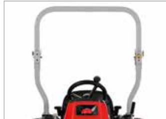
Equipados de serie con rollbar, parachoques delantero y trasero, protecciones laterales y cinturones de seguridad con el fin de garantizar la máxima seguridad durante el trabajo aun en las situaciones más complejas (**CHEYENNE**).
