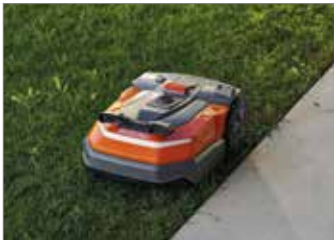
O robot corta-relva corta primeiro ao longo da linha de fronteira de modo a cortar o mais próximo possível da borda do relvado.
