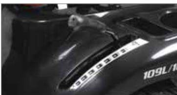
Regulação da altura de corte através de uma prática alavanca colocada à mão, com uma escala graduada que permite uma visualização imediata do nível de altura de corte desejado.
