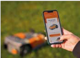
Possibilidade de gerir o robot corta-relva diretamente a partir do smartphone: receber notificações em caso de problemas, enviar comandos de arranque/estacionamento.
