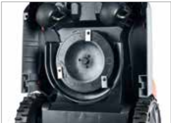
Possibilidade de guardar o robot corta-relva na posição vertical para armazenamento ou limpeza da unidade de corte.
