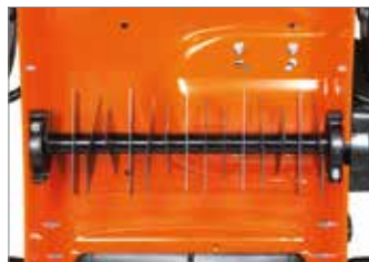
Rotor composto por 15 lâminas fixas.
