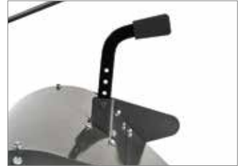
Fresa de 50 cm com regulador de profundidade.
