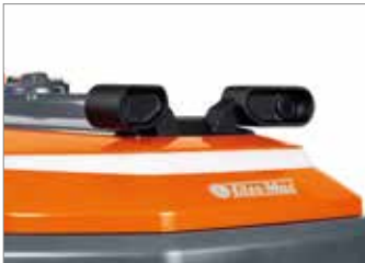
Deteção de obstáculos por ultrassons para aumentar o desempenho e a segurança do robot; o sensor (opcional) pode detetar obstáculos de 10 cm de largura e 15-20 cm de altura na parte dianteira. 67040043
