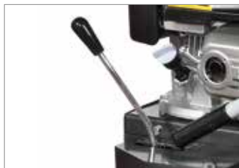
Comando seletor das velocidades com alavanca.
