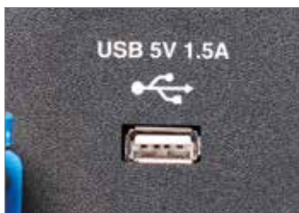
Saída com tomada USB para alimentar diretamente equipamentos elétricos.
