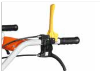
Alavanca no guiador para engate das mudanças.
