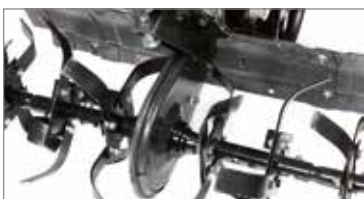
Посилений картер трансмісії для захисту від каміння чи випадкових ударів.
