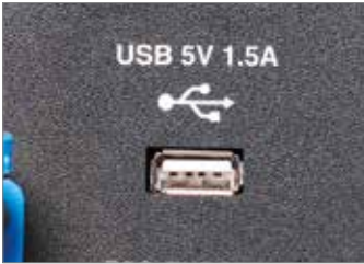
Вихід із USB-роз'ємом для прямого електроживлення електронного обладнання.
