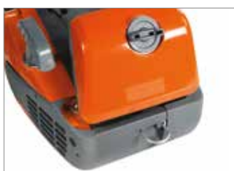
Замок для карбіна: складається, зроблен зі сталі, розрахован для швидкої зв'язки машини з оператором.
