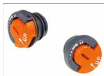
Пробки баків для оливи та суміші "EasyLift" є найбільш практичним рішенням для забезпечення легкого доступу до точок заправки. Ергономічна верхня частина пробки дозволяє користуватися ними без застосування інструментів.
