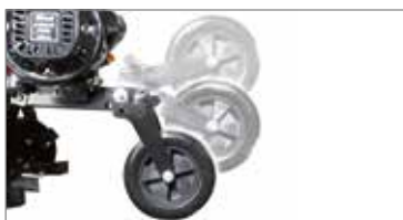
Переднє колесо, необхідне під час транспортування машини, можна підняти для більшої зручності оранки.
