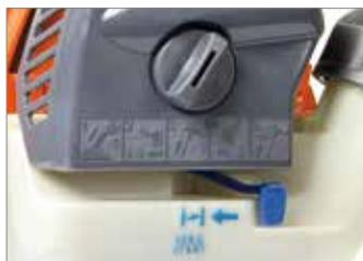
A representação gráfica das fases de arranque facilita a ignição da máquina, mesmo para os operadores menos experientes (modelos **BC 241**).
