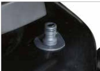
O conector rápido, "Deck Wash System", situado diretamente no prato de corte, permite conduzir a água diretamente para o interior facilitando, assim, as operações de limpeza do acessório de corte (84).
