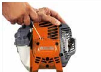
Sistema "EasyOn" de arranque facilitado: reduz os contragolpes na fase de ignição.
