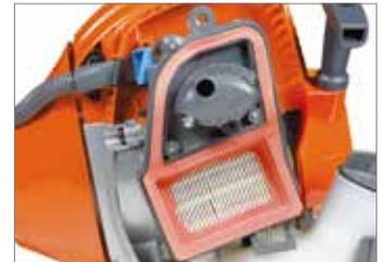
Filtro de ar em papel de amplas dimensões para uma maior capacidade filtrante e uma longa autonomia de trabalho.
