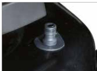
O conector rápido, "Deck Wash System", situado diretamente no prato de corte, permite conduzir a água diretamente para o interior facilitando, assim, as operações de limpeza do acessório de corte.
