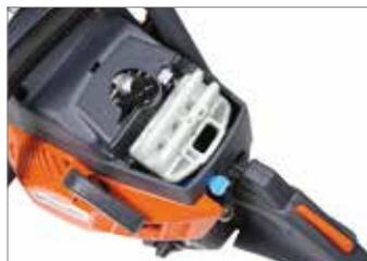
Filtro de nylon para **GS 371** e **GS 411**: graças a uma elevada superfície de filtração, aumenta as horas de autonomia de trabalho entre uma limpeza do filtro e a seguinte.
