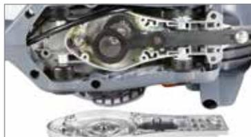
Caixa de engrenagens profissional em alumínio, mecanismo com pinhão sobre rolamentos, e bielas com rolamento de agulhas: garantem longa duração, silêncio e baixas vibrações.
