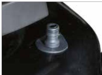
O conector rápido, "Deck Wash System", situado diretamente no prato de corte, permite conduzir a água diretamente para o interior facilitando, assim, as operações de limpeza do acessório de corte (**103**).
