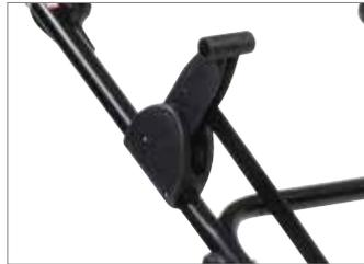
Prática alavanca de regulação da profundidade de trabalho. Situada ao lado do guiador, torna as regulações rápidas e fáceis durante a utilização da máquina.
