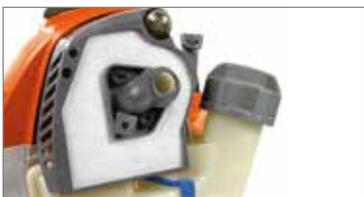
Suporte do filtro com díodo anti-resíduos do combustível (patente Emak): impede que o filtro fique impregnado de mistura e garante uma maior autonomia de trabalho entre as manutenções.
