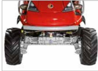
O piso de amplas dimensões e baixo centro de gravidade da máquina permitem a máxima estabilidade mesmo em terrenos irregulares ou próximo de margens de rios e valas.
