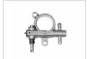
Bomba de óleo em alumínio regulável: facilita o trabalho do operador permitindo variar o fluxo do óleo em função da utilização da máquina e do acoplamento barra/corrente. O fluxo nulo do óleo com o motor em ralenti assegura um menor consumo e uma maior proteção do meio ambiente.
