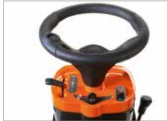
O engate da embraiagem eletromagnética ocorre rapidamente e de modo silencioso através de um cómodo botão situado no painel de comandos.
