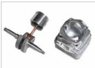
Pistão de 2 segmentos elásticos, cambota e biela em aço forjado e trabalhado, rolamentos de agulhas, cilindro revestido a níquel: asseguram um rendimento constante ao longo do tempo, mesmo no caso de utilização exigente (GS 371, GS 411).
