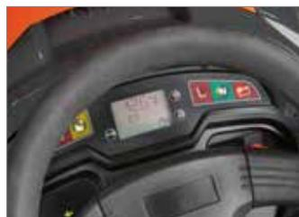
O display eletrônico LCD permite uma visualização rápida e imediata das principais informações do mini-trator como, por exemplo, horas de funcionamento, tensão da bateria, nível do depósito de combustível (123).
