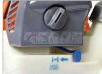
A representação gráfica das fases de arranque facilita a ignição da máquina, mesmo para os operadores menos experientes (modelos **BC 241**).
