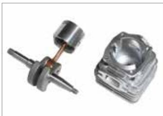
Pistão de 2 segmentos elásticos, cambota e biela em aço forjado e trabalhado, rolamentos de agulhas, cilindro com aplicação em níquel: asseguram um rendimento constante ao longo do tempo, mesmo no caso de utilização exigente.
