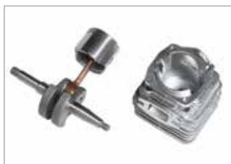
Pistão de 2 segmentos elásticos, cilindro de fundição injetada com aplicação em níquel, biela e cambota forjada: garantem ao motor uma grande resistência e duração ao longo do tempo.
