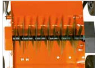
Rotor composto por 15 lâminas fixas.
