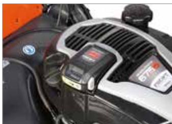
O modelo **TBXE** com motor Briggs & Stratton é dotado de arranque elétrico com bateria recarregável, que assegura um arranque facilitado.
