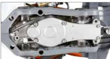
Sistema anti-vibratório composto por 4 molas que garante um total isolamento das mãos do utilizador.
