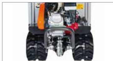
Protección trasera en metal para mayor seguridad del operador.
