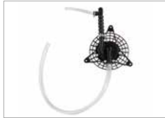
La bomba de empuje o booster mantiene mezclada la solución de líquidos en el depósito y, al mismo tiempo, aumenta y estabiliza el caudal de salida del producto. Para MB 90/MB 900 se ofrece también la versión "llenado", que permite cargar el depósito sin quitarse la máquina de la espalda.
