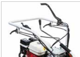
Dirección con desbloques y frenos independientes.
