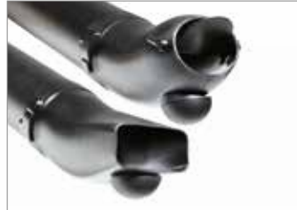
Dos boquillas de salida de aire incluidas de serie: de sección rectangular y circular, ambas dotadas de una semiesfera que permite apoyarlas en suelos llanos para descanso del operario (BV 901).
