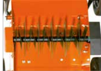
Rotor compuesto por 15 cuchillas fijas.
