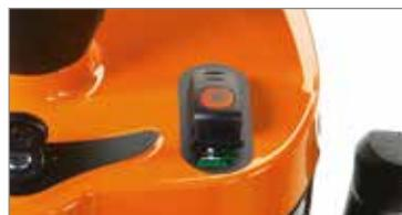
Включение электромагнитной муфты производится быстро и бесшумно нажатием кнопки, удобно расположенной на приборной доске.
