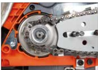
Сцепление "OnBoard": быстрая установка режущего элемента, меньшая степень загрязнения муфты сцепления, что обеспечивает неизменные с течением времени характеристики.
