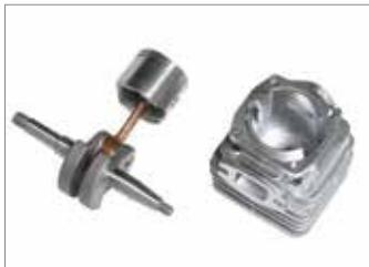
Поршень из 2 упругих элементов, вал и шатун из кованой и обработанной стали, роликовые сепараторы, цилиндр с никелированным покрытием: обеспечивают неизменную во времени производительность даже в тяжелых условиях эксплуатации.
