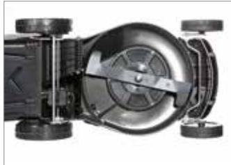
Корпус из литого алюминия толщиной 4 мм обеспечивает малый вес и высокую механическую стойкость к износу и коррозии.
