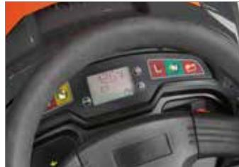
Электронный ЖК-дисплей мгновенно отображает основную информацию по минитрактору-газонокосилке, например, часы наработки, напряжение батареи, уровень топлива в баке (123).
