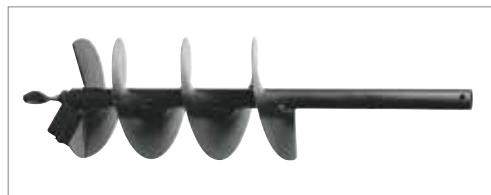
Однозаходные шнеки доступны как с одинарной, так и с двойной режущей кромкой (последняя обеспечивает лучшее проникновение в землю и облегчает выемку грунта). Оснащены наконечником и режущей кромкой из специальной стали для обеспечения максимальной производительности и износостойкости. Совместимость с:
