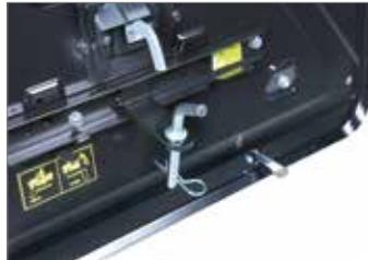
Буксировочный крюк серийного оснащения делает машину еще более универсальной благодаря возможности буксировать тележку или каток (93).
