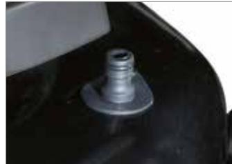
Быстроизъемное соединение "Deck Wash System", установленное прямо на режущей деке, позволяет направлять воду непосредственно вовнутрь, тем самым облегчая операции по очистке режущего аппарата (103).
