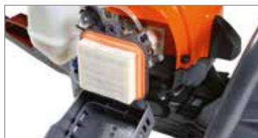
Бумажный воздушный фильтр с увеличенной фильтрующей поверхностью обеспечивает увеличение фильтрующей способности и лучшую защиту двигателя, даже при работе в условиях сильной запыленности.
