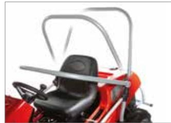
Серийное оснащение включает поперечную стойку, передний и задний бамперы, боковые защитные кожухи и ремни безопасности для обеспечения максимальной защиты при работе даже в самых сложных условиях.
