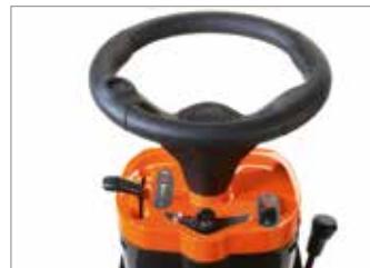
Включение электромагнитной муфты производится быстро и бесшумно нажатием кнопки, удобно расположенной на приборной доске.
