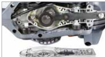
Профессиональный корпус редуктора из алюминия, кинематический механизм с зубчатым зацеплением на подшипниках и шатуны с роликами качения обеспечивают долгий срок службы, малый уровень шума и низкую вибрацию.
