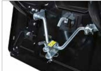
Буксировочный крюк серийного оснащения делает машину еще более универсальной благодаря возможности буксировать тележку или каток.
