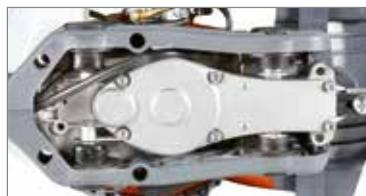
Антивибрационная система из 4 пружин обеспечивает полную виброизоляцию рук оператора.
