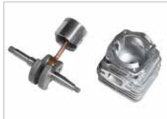
Поршень с 2-мя упругими сегментами, литой цилиндр с никелевым покрытием, кованые шатун и вал двигателя обеспечивают прочность и продолжительный срок службы.
