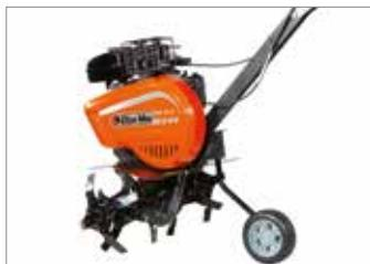
Колесо заднего хода служит для перемещения машины.
