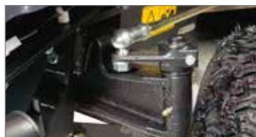
Передний мост выполнен из стального литья для обеспечения работы в наиболее экстремальных условиях и устойчивости к возможным ударам.
