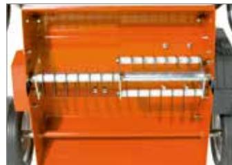
Ротор с 28 плавающими ножами на шариковых подшипниках и система смазки.
