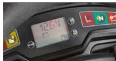
ЖК-дисплей мгновенно отображает основную информацию по минитрактору-газонокосилке, например, часы наработки, напряжение батареи, уровень бензина и масла в баке.
