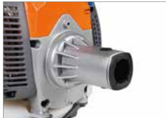
Кожух с алюминиевой опорой для сцепления сочетает в себе прочность и легкость, обеспечивая долговременную надежность.
