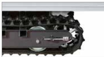
Прочное шасси с натяжителем гусениц идеально сбалансировано для обеспечения правильного распределения груза в кузове и хорошего сцепления с любым грунтом.
