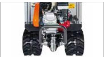
Расположенное с задней стороны металлическое ограждение обеспечивает безопасность оператора.
