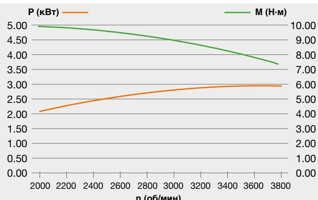
**Примечание:** двигатель с тяжелым маховиком, подходящий для условий эксплуатации, при которых требуется более высокий момент инерции.
