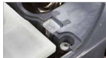
«Противообледенительное устройство»: позволяет работать без проблем даже при низких температурах (ниже 0°C), предупреждая образование льда на воздушном фильтре.
