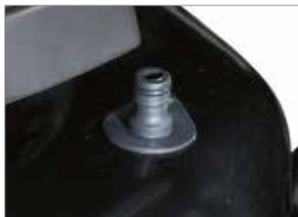
Быстроразъемное соединение "Deck Wash System", установленное прямо на режущей деке, позволяет направлять воду непосредственно вовнутрь, тем самым облегчая операции по очистке режущего аппарата (**84**).
