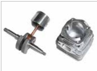
Поршень с 2-мя упругими сегментами, вал и шатун из кованой и механически обработанной стали, роликовые сепараторы и цилиндр с никелированным покрытием: обеспечивают неизменную во времени производительность даже в тяжелых условиях эксплуатации (**GS 371, GS 411**).
