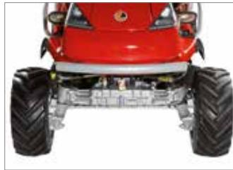
Широкие покрышки колес с заниженным центром тяжести машины обеспечивают максимальную устойчивость даже на наклонных участках или вблизи рек и канав.
