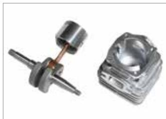
Поршень из 2 упругих элементов, вал и шатун из кованой и обработанной стали, роликовые сепараторы и цилиндр с никелированным покрытием обеспечивают неизменную во времени производительность даже в тяжелых условиях эксплуатации.
