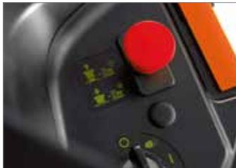
Включение электромагнитной муфты производится быстро и бесшумно нажатием кнопки, удобно расположенной на приборной доске.
