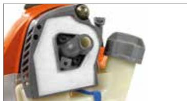
Держатель фильтра оснащен специальным диодом (патент Emak): он предотвращает насыщение фильтра топливом и, тем самым, обеспечивает увеличенную автономию работы и больший интервал между техобслуживаниями.
