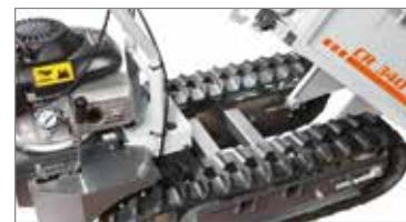
Прочная стальная рама. Заниженный центр тяжести обеспечивает оптимальную устойчивость даже при работе на склонах. Высокое расположение двигателя и трансмиссии способствует удобству техобслуживания.
