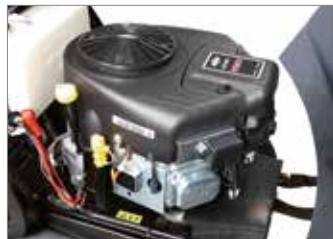
Двухцилиндровый двигатель Briggs&Stratton для различных видов работ на поверхностях площадью до 9000 м<sup>2</sup>.
