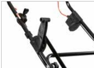
Практичный рычаг для регулировки глубины обработки. Расположен сбоку от руля и позволяет быстро и легко выполнять регулировки в процессе работы с машиной.
