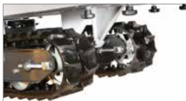
Широкие гусеницы обеспечивают хорошее сцепление с любыми типами грунтов (безопасность для оператора).
