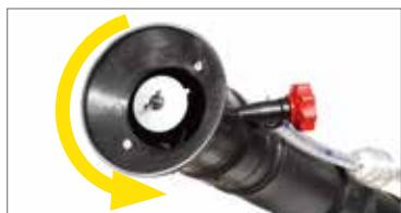
Угол раскрытия струи можно быстро и удобно отрегулировать, не прерывая работу, что позволяет обрабатывать каждую культуру нужным способом.
