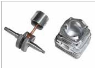
Поршень из 2 упругих элементов, вал и шатун из кованой и обработанной стали, роликовые сепараторы, цилиндр с никелированным покрытием: обеспечивают неизменную во времени производительность даже в тяжелых условиях эксплуатации.
