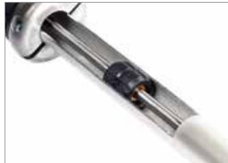
Жесткий трансмиссионный вал диаметром 8 мм: высокая надежность обеспечивается благодаря жесткому трансмиссионному валу, врачающемуся на 6 самосмазывающихся втулках.
