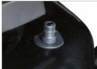
Быстроизъемное соединение "Deck Wash System", установленное прямо на режущей деке, позволяет направлять воду непосредственно вовнутрь, тем самым облегчая операции по очистке режущего аппарата.
