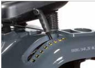
Удобно расположенный, практичный, 7-позиционный рычаг регулировки высоты среза с градуированной шкалой позволяет мгновенно определять желаемый уровень высоты среза.
