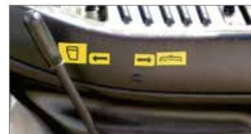
Система “Change over” позволяет с помощью удобного рычага закрывать канал выброса, автоматически переводя машину из режима сбора скошенной травы в режим мульчирования.
