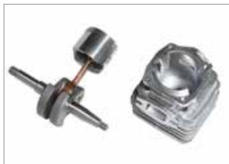
Поршень с 2-мя упругими сегментами, вал и шатун из кованой и механически обработанной стали, роликовые сепараторы и цилиндр с никелевым покрытием: обеспечивают постоянную производительность с течением времени даже в случае интенсивного использования.
