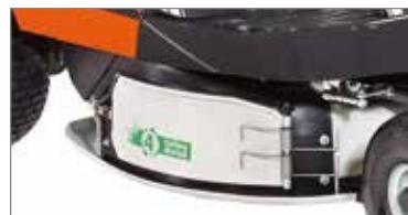
“4-cutting device”: универсальная система резки, включающая в себя мульчирование, сбор, стандартный боковой выброс и дефлектор для заднего выброса.
