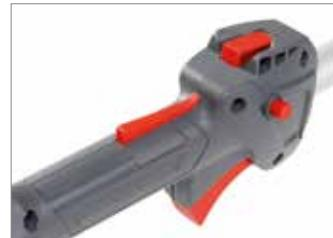
Система AlwaysOn: выключатель Вкл./Выкл. автоматически возвращается в положение включения после каждого выключения, предупреждая заклинивание двигателя.
