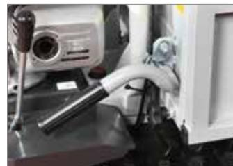
Ручное опрокидывание с автоматической системой блокировки.
