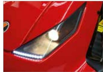
Передние фары с галогенными и светодиодными лампами обеспечивают хорошую видимость в зоне резки даже в темное время суток.
