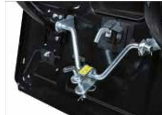
Буксировочный крюк серийного оснащения делает машину еще более универсальной благодаря возможности буксировать тележку или каток (103).
