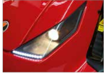
Feux avant avec ampoules halogènes et à led assurant une bonne visibilité sur la zone à tondre et lorsque l'éclairage est mauvais.
