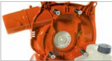
Système antivibrations professionnel "VibCut", monté sur 4 ressorts d'amortissement en acier : l'opérateur ne perçoit aucune vibration.
