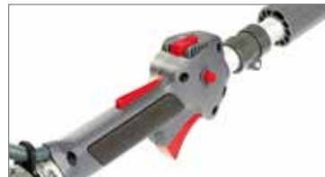
L'interrupteur on/off « AlwaysOn » retourne automatiquement sur la position de démarrage chaque fois que l'on arrête le moteur, ce qui évite de le noyer.
