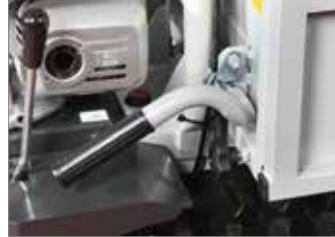
Renversement manuel avec système de blocage automatique.
