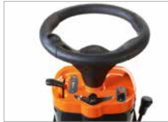
L'embrayage électromagnétique s'engage rapidement et sans bruit grâce à une commande spécifique au tableau de bord.
