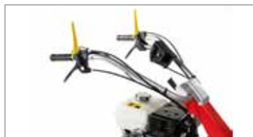
Leviers de commande (déverrouillage, freins et vitesses) ergonomiques et regroupés à portée de main.
