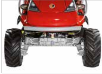
La bande de roulement de grandes dimensions et le centre de gravité abaissé assurent une stabilité optimale même sur terrains accidentés ou à proximité de cours d'eau ou de fossés.
