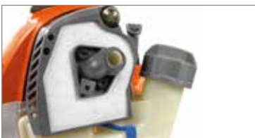
Support de filtre avec diode antireflux de carburant (brevet Emak) : empêche le filtre de s'imprégner de mélange et garantit une meilleure autonomie de travail entre un entretien et l'autre.
