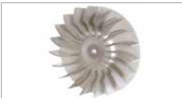
Ventilateur à double rang d'ailettes afin d'augmenter le débit et la vitesse et, par conséquent, la capacité de refroidissement du groupe thermique.
