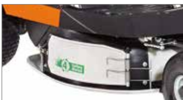
'4-cutting device': veelzijdig maaisysteem inclusief mulching, opvang, standaard zijuitworp en deflector voor achteruitworp.
