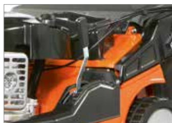
Gecentraliseerde regeling van de maaihogte met een comfortabele hendel met vaste standen.
