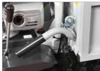
Handmatige kanteling met automatisch blokkeersysteem.
