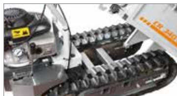
Stevig frame met stalen structuur. Het lage zwaartepunt biedt een optimale stabiliteit tijdens het werken, ook op hellende terreinen. De hoge plaatsing van de motor en de transmissie vergemakkelijkt het onderhoud.
